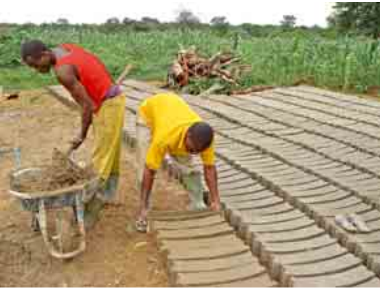
La costruzione di un pozzo rivestito richiede 66 mattoni al metro, cioè 1980 per un pozzo di 30 metri
